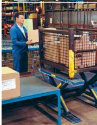
Figure 18 Plateforme mobile électrique utilisée pour le chargement et le déchargement des caisses de marchandises.
